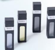
Set de filtros de ensayo para control de calidad interno
