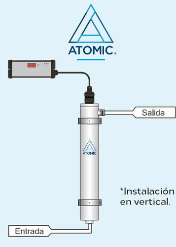
\*Se recomienda la instalación del sistema de manera vertical para un mejor manejo y reemplazo de los componentes.
