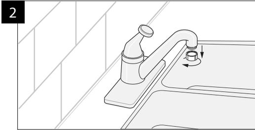
3. Conecte la válvula derivadora de flujo de su equipo sobre tarja al grifo de la tarja de su cocina, apretando solo manualmente (no use herramientas). Esta válvula derivadora cuenta con un sistema On - Off (derecha-izquierda) muy simple y sencillo. Colóquelo en posición "Off".
